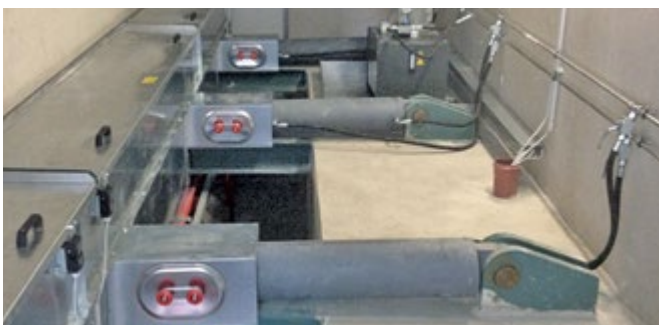
Massive Hydraulikzylinder zur Schubbodenbewegung
