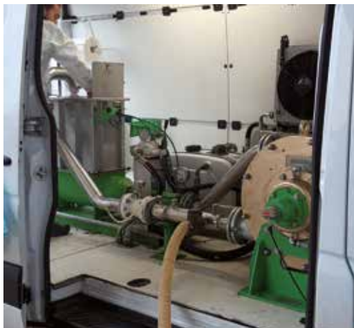
Cavitatore mobile utilizzato nelle prove
