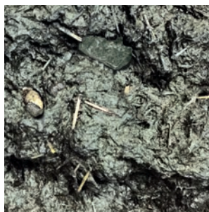
Substrat wcześniej: duży, z materiałami zakłócającymi pompowanie mediów
